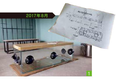
2017年8月 フレームは鉄骨で製作し、新潟から東京への運搬も考慮し分解できるように設計。
